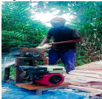
Gambar 5. Pemarutan atau proses penghancuran batang sagu yang menghasilkan slurry sagu dilakukan oleh masyarakat desa kelaba.
