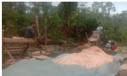
Gambar 6. Proses pengepresan dan penyaringan slurry sagu agar mendapatkan pati sagu yang dilakukan oleh masyarakat desa rumoga.
