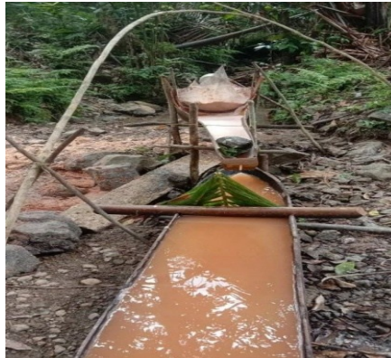
Gambar 7. Proses pengendapan pati sagu yang dilakukan oleh masyarakat desa rumoga.
